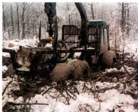
Figure 13. Limited soil strength Slika 13. Tlo ograničene nosivosti
